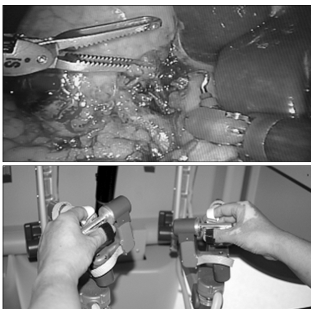
그림 5. 수술 콘솔에 앉아서 수술을 진행하는 수술자의 손모습(아래)과 복강내의 실제 수술장면(위)사진.
