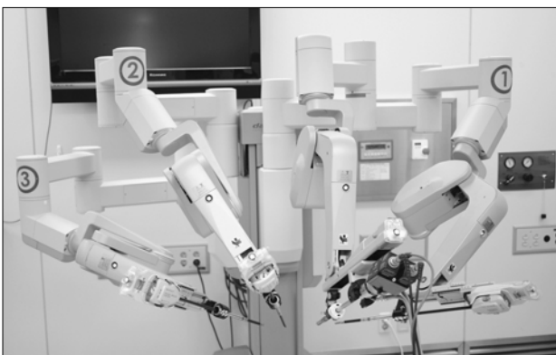
그림 2. 다빈치 시스템의 로봇 카트 사진(4개의 로봇 팔을 가지고 있음).
