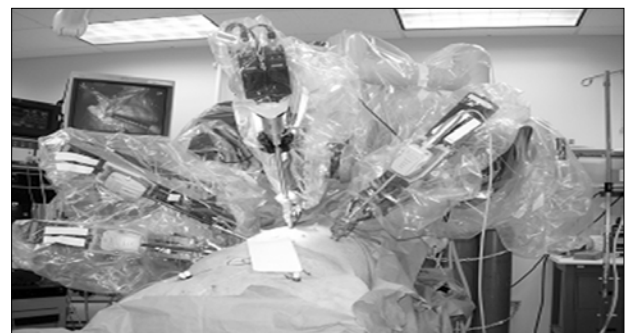
그림 4. 다빈치 시스템의 로봇 카트가 연습용 돼지에게 적용되어 실제 수술이 이루어지고 있는 모습.
